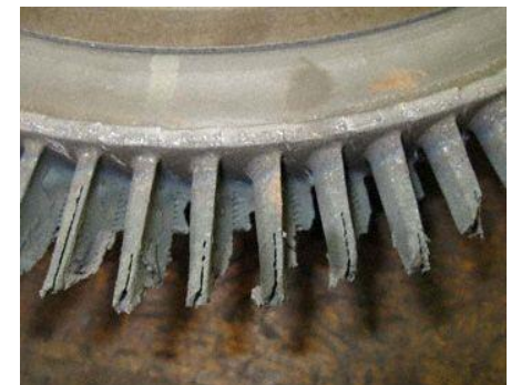
Thermal hotspot melt out
