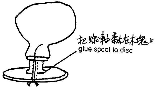
吹大氣球，放在線軸上。 空氣衝擊木塊底起摩擦作用。 將整個裝置移動滑至很遠。
