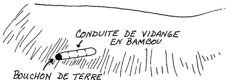
Un des meilleurs moyens pour vider un étang, consiste à placer une conduite en bambou ou en plastique à travers la base de la paroi au milieu de l'étang. Le bout de la conduite qui se trouve dans l'étang comporte un filtre pour empêcher les poissons d'y pénétrer. L'autre bout, celui qui se trouve à l'extérieur, est bouché avec du bois ou de l'argile. C'est ce bouchon que l'on enlève pour vider l'étang du moment de la récolte.
