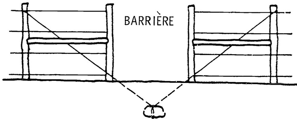
Un poids mort utilisé pour soutenir deux poteaux. Le poids mort crée une poussée sur les poteaux égale à celle créée par la tension du fil de fer tendu dans le sens opposé.
