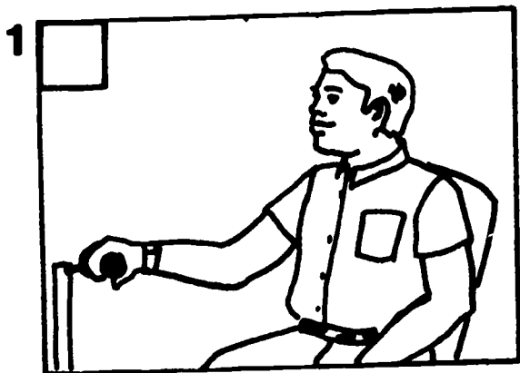
El conductor mueva la válvula obturadora de vapor.
