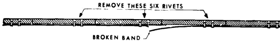
STEP II TRIM BROKEN STEEL BAND AS SHOWN
