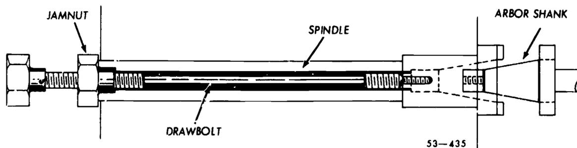
Figure 5 Spindle drawbolt.
