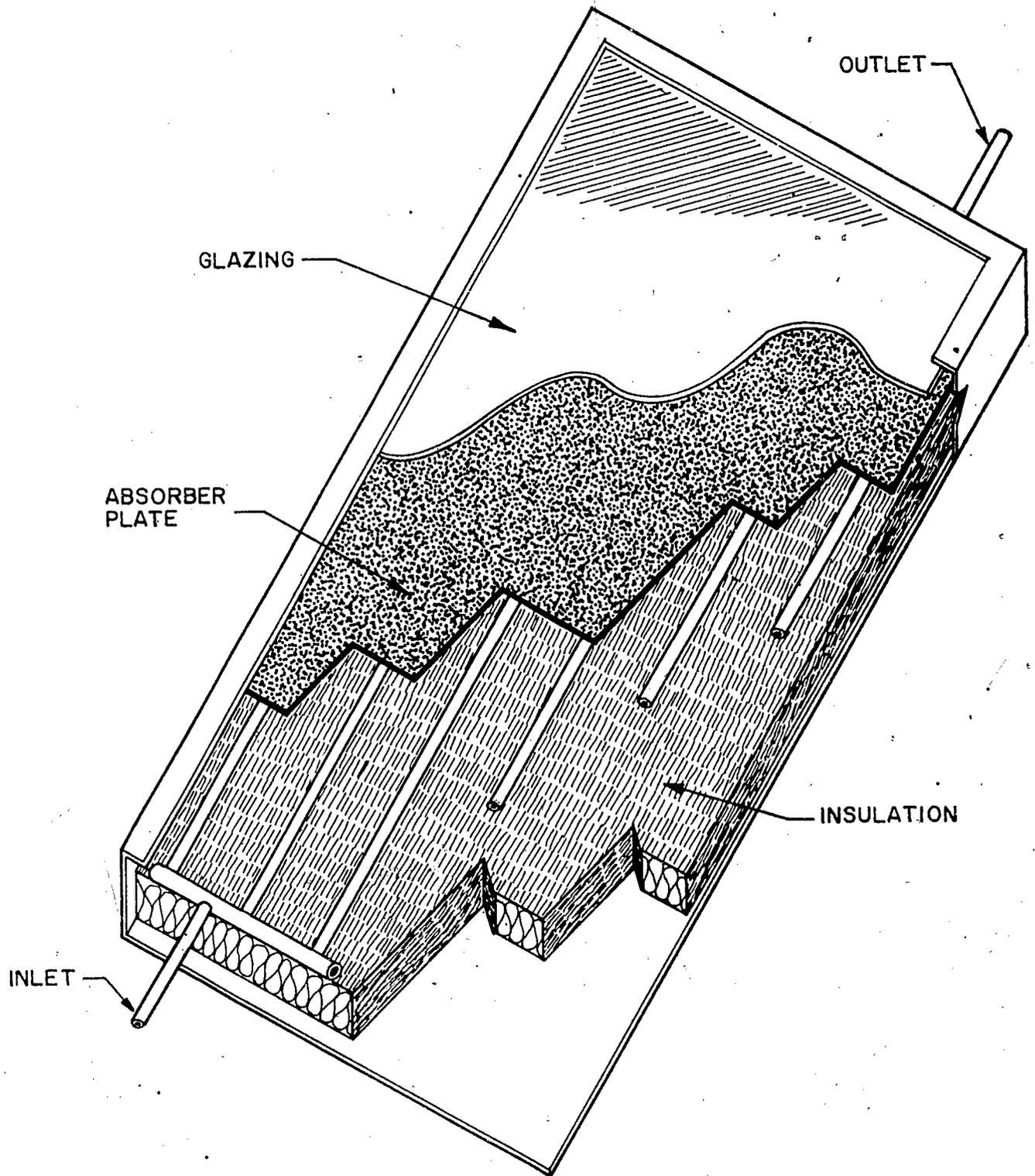
CUT-AWAY OF LIQUID FLAT PLATE COLLECTOR
