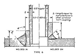
FIG. 13(G) WELDED HALF TAPPED COUPLING\*
