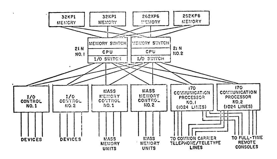
Fig. 7: Redundant System
