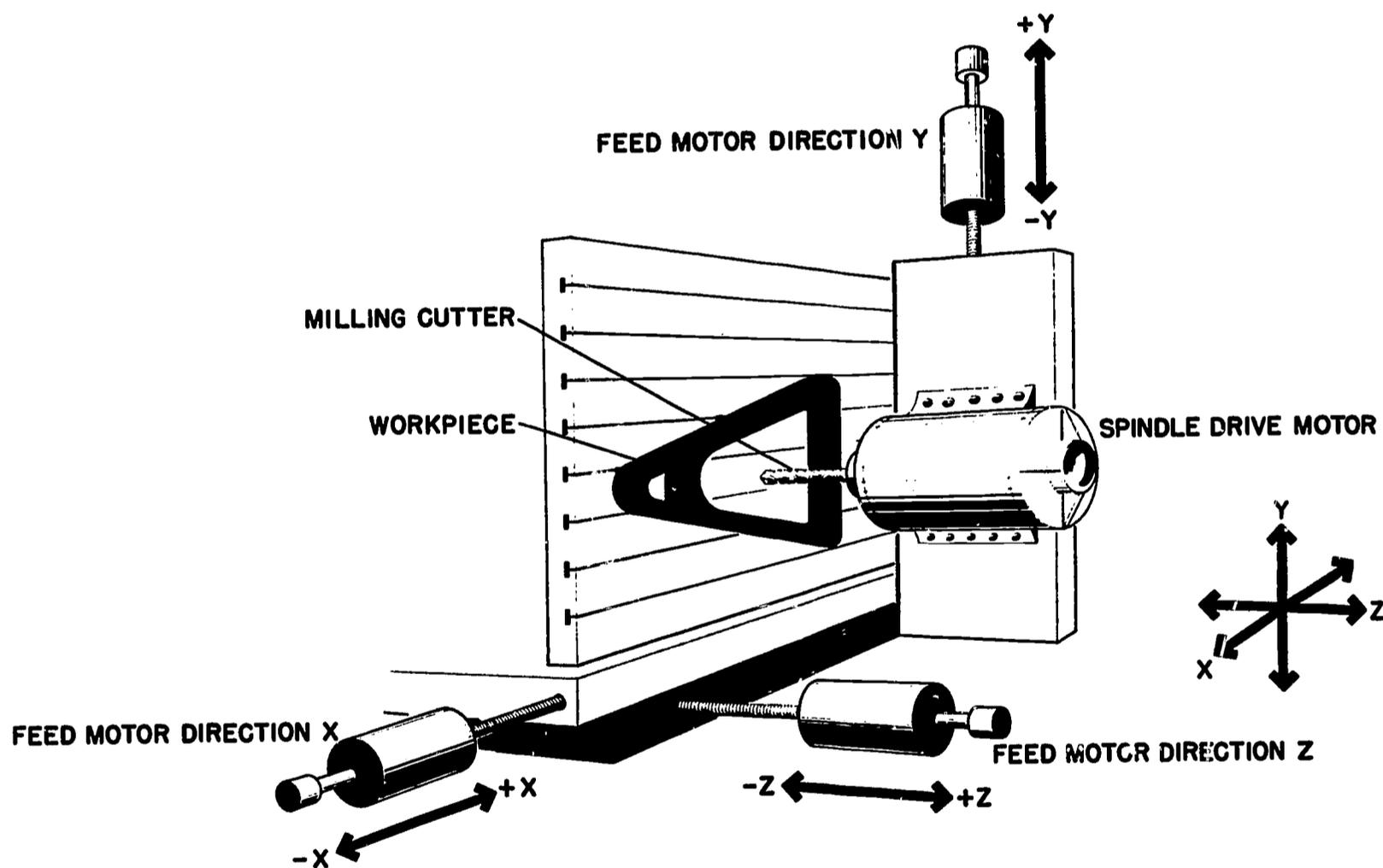
Fig. 7—1. Machine axis designation
